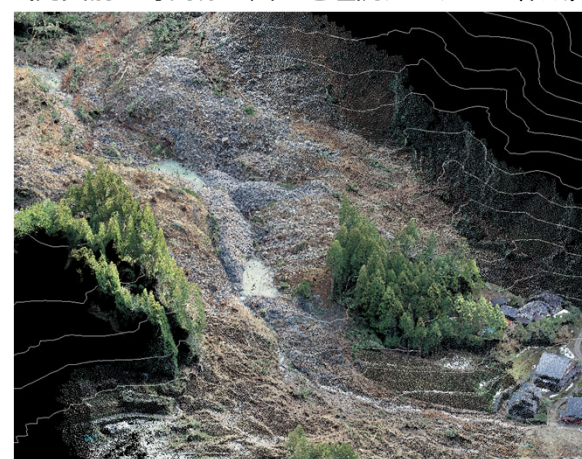
河道閉塞部のバーチャル被災現場 (北陸地整TEC-FORCE撮影のUAV画像から作成)
